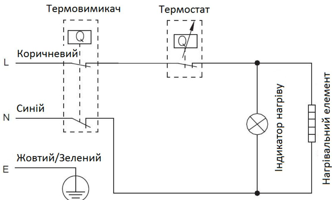
Водонагрівач розрахований на підключення до електромережі з одною фазою, напругою 230В, частотою 50 Гц.
